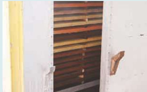
Pengeringan kayu keras ringan campur di dalam pengering eksperimen Drying of mixed light hardwood in an experimental dryer
