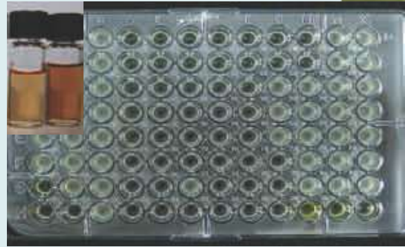
'Microtiter plate assay' dalam ujian aktiviti antibakteria daripada ekstrak kulat Microtiter plate assay in antibacterial activity testing from fungal extracts
