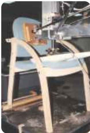
Ujian kekuatan dan ketahanan untuk kerusi Strength and durability test for chair
