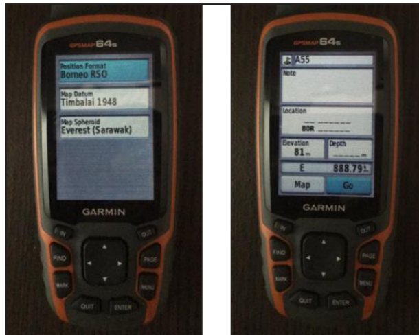
Rajah 5: Tiada Paparan Nilai Koordinat di Dalam Handheld GPS Ketika Berada di Kawasan Sekitar Semantan, Negeri Sarawak
