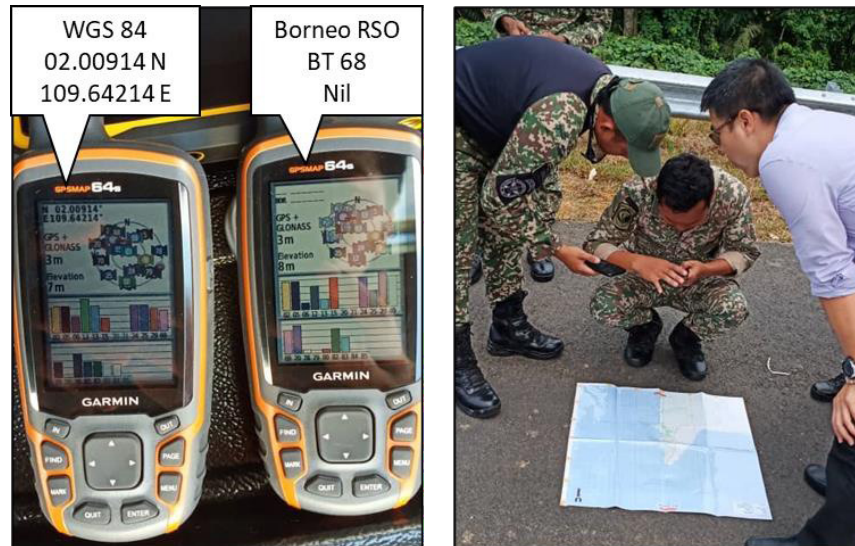
Rajah 9: Bacaan Secara Manual bagi Rujukan Grid Peta Topografi Indeks Syit 5014 Semantan dan Paparan Bacaan Nilai Koordinat GPS Pada Alat Handheld GPS di Lapangan
