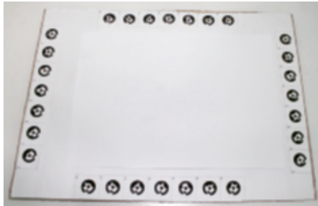
Rajah 6: Sasaran Lingkaran Pengesanan Automatik (RAD) berkode dilekatkan di atas templet putih
