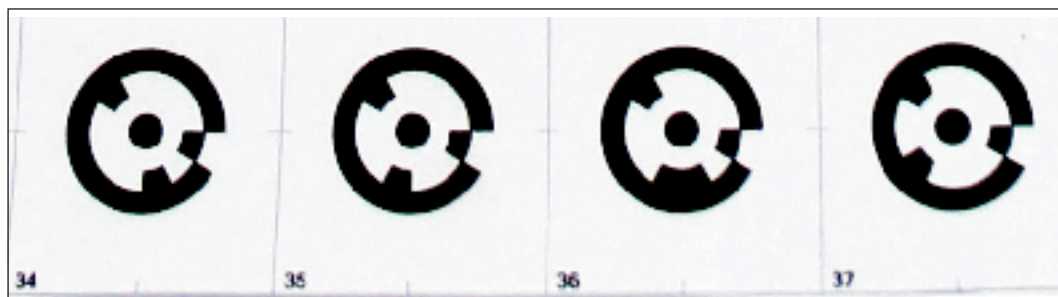
Rajah 5: Sasaran Lingkaran Pengesanan Automatik (RAD) berkod
