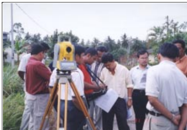
Anggota JUPEM sedang menggunakan peralatan Rugged Pen Based Notebook bersama alat Total Station Trimble 3605
