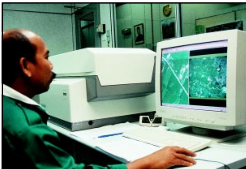
Kaedah imbasan daripada negatif fotoudara berwarna digunakan untuk membuat mozek sesuatu kawasan
