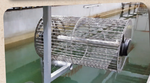
Uji lari alat pengasingan kerang ( Hydro Cockles Sorter, HCS ) di Pusat Teknologi Marin, Universiti Teknologi Malaysia, Skudai, Johor.
