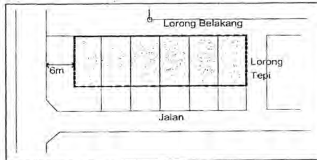
Rajah 10.5 : Anjakan Sisi Bangunan yang Bersebelahan Dengan Rizab Jalan
