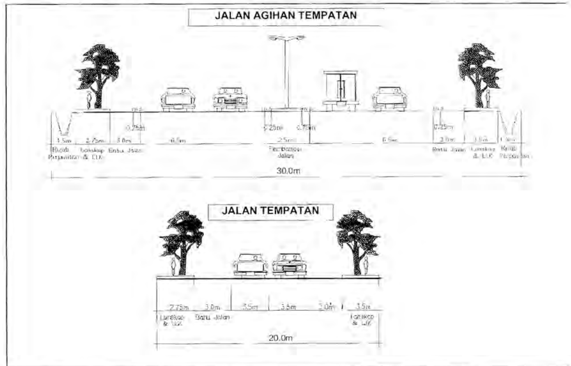
Rajah 9.6 : Hierarki dan Keratan Jalan Di Dalam Kawasan Perumahan
