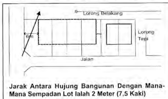
Rajah 10.8 : Jarak Antara Hujung Bangunan Dengan Mana-Mana Sempadan Lot
