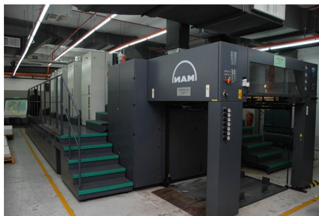
Gambar 4: Mesin Cetak Ofset 4 Warna Man Roland R-904
